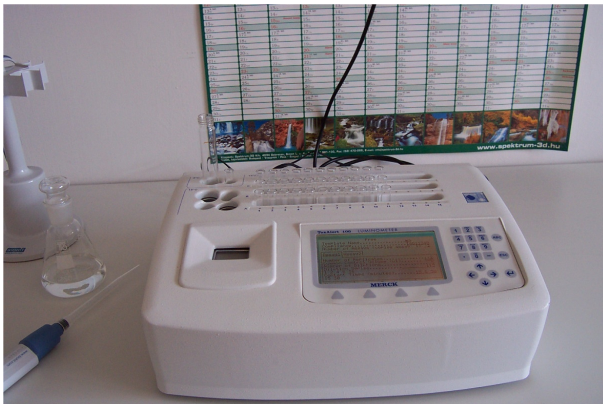
37. ábra ToxAlert®100 luminométer (Fotó Kovács Nóra)
