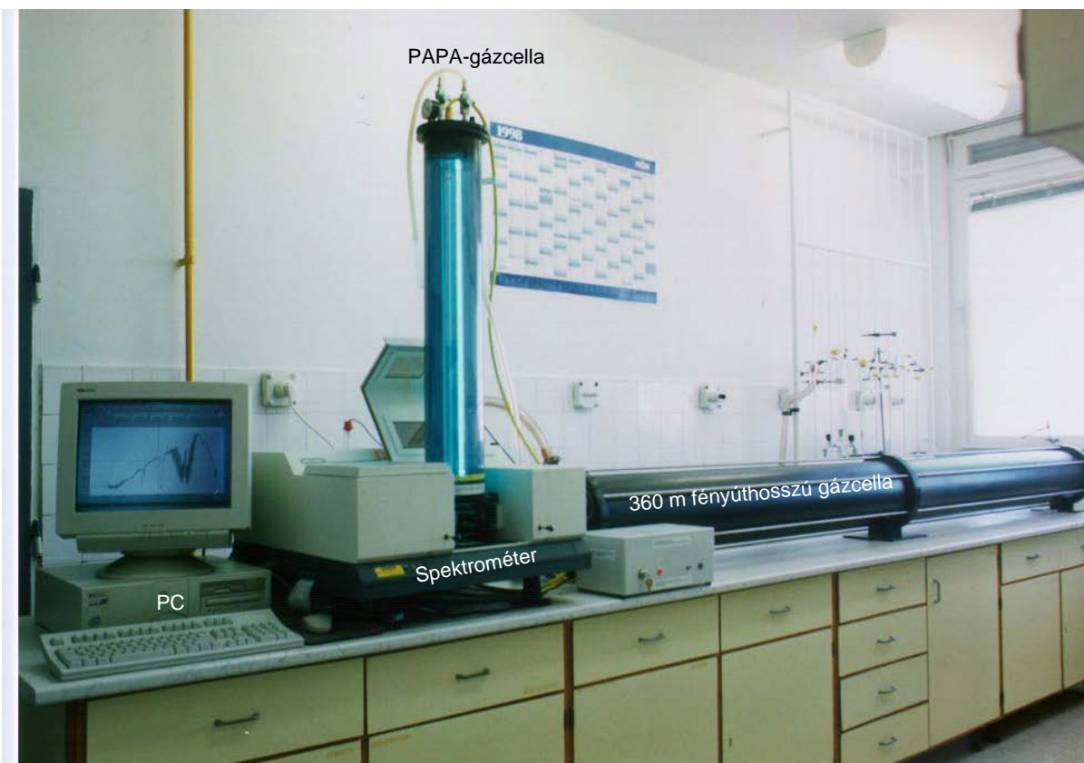
68. ábra Egy vertikális (25,7 m úthosszú) és egy horizontális (360 m úthosszú) gázcellával felszerelt korszerű FTIR spektrométer (Pannon Egyetem Analitikai Kémia Tanszék)
