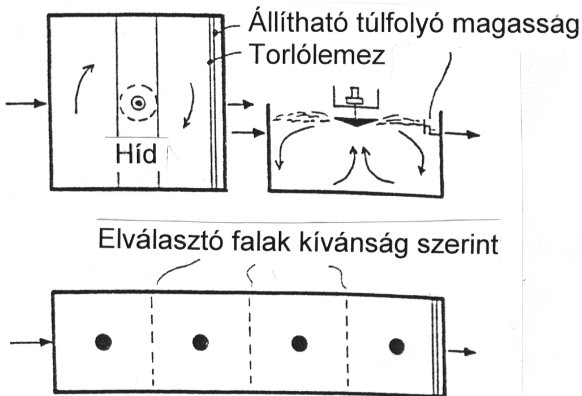
53. ábra. Levegőztető medencék függőleges tengelyű felületi levegőztetőkkal.
