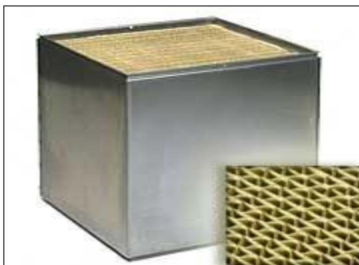
87. ábra Erőművi SCR konverter (fém-monolitváz) katalizátor: \text{V}_2\text{O}_5\text{-TiO}_2/\text{Al}_2\text{O}_3
