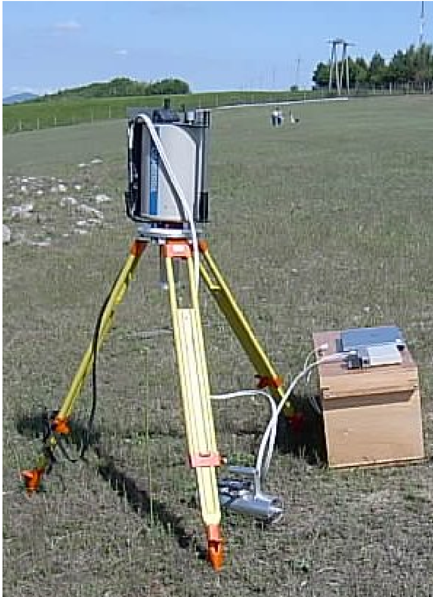
150. ábra. Egy mobil gammaspektrometriai mérőrendszer a detektorral és a kapcsolódó elektronikával.
