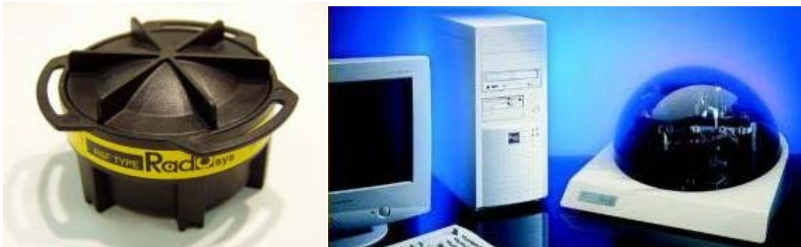
48. ábra. A radosys rendszer detektor tartója és a kiértékelő rendszer.
