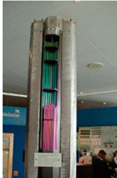
103. ábra. Üzemanyag kazetta mérethű hasonmása a paksi látogató központban.
