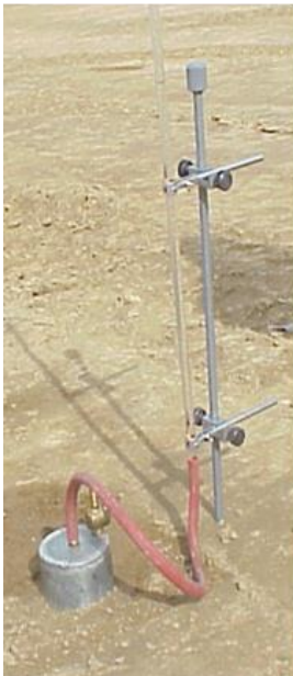
245. ábra: Takaró réteg építése, tömörítése és helyszíni k-tényező mérés infiltróméterrel (MECSEK-ÖKO Zrt)
