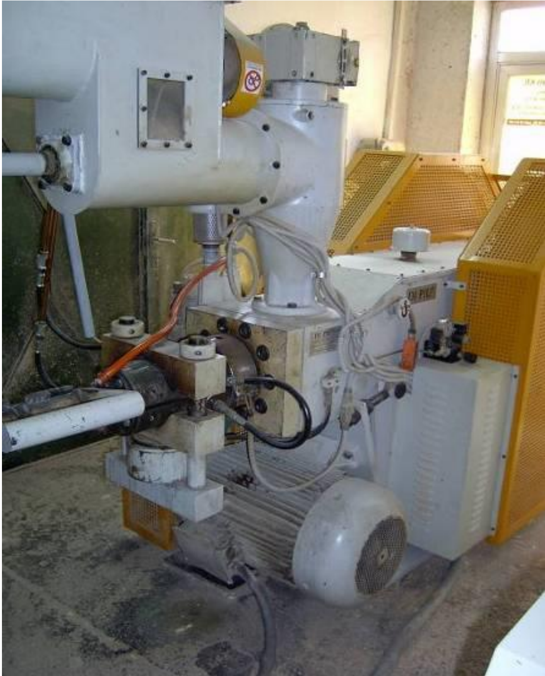
128. ábra: Brikettáló gép (Marosvölgyi, 2002)
