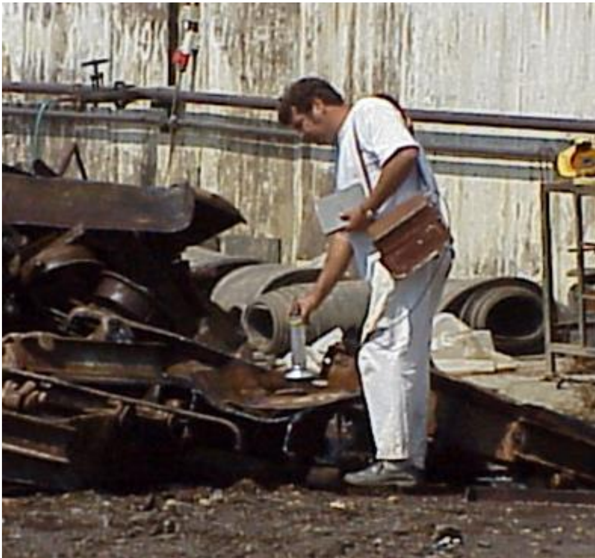
230. ábra: Fémhulladékok radiometriai ellenőrzése
