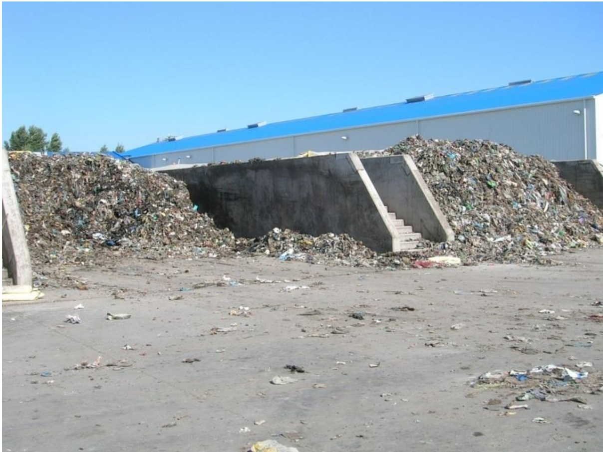
67. ábra: Stabilizált hulladék a kezelés után (© Buruzs, 2010)
