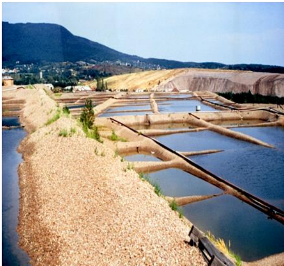
239. ábra: Alacsony minőségű ércek feldolgozása perkolációval, Perkoláció-II terület (MECSEK-ŐKO Zrt)
