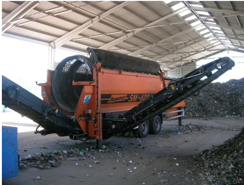
68. ábra: Stabilizált hulladék dobrostán történő osztályozása (© Buruzs, 2010)
