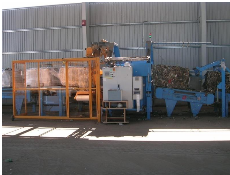
69. ábra: 4. kép: Többrétegű fóliába csomagoló bálázóba (© Buruzs, 2010)
