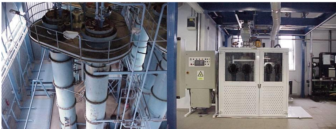
252. ábra: A bányavíz tisztító szorpciós oszlopai és a koncentrátum csomagoló egység (MECSEK-ÖKO Zrt)
