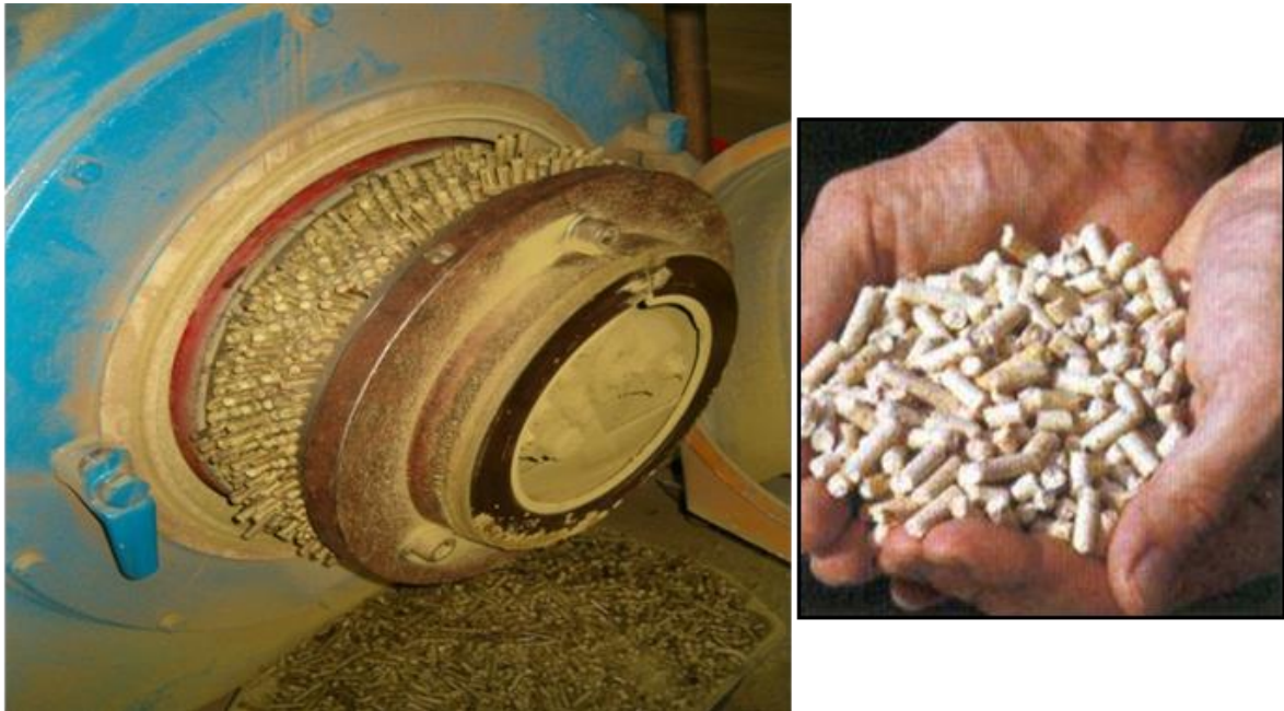
131. ábra: Pelletáló berendezés és a pellet (Marosvölgyi, 2002)
