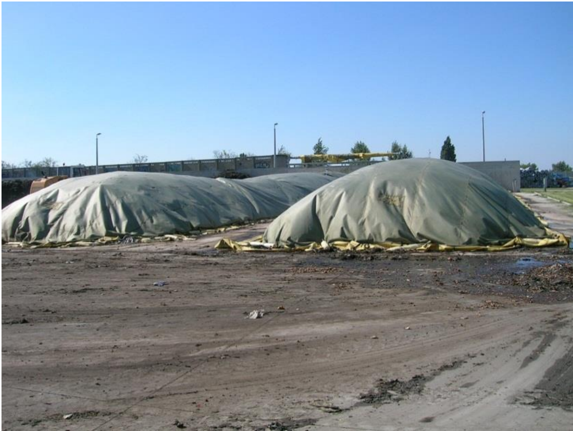
70. ábra: Nyílt rendszerű prizmás komposztálás (© Buruzs, 2010)
