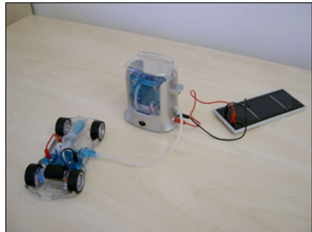
139. ábra: Tüzelőanyag cellás modellek (Modellre szerelt napelemmel; Modellhez kapcsolható napelemmel; Hidrogén-oxigén kutató működtető napelemmel; A napelemek a vízbontás energiáját fedezik.)
