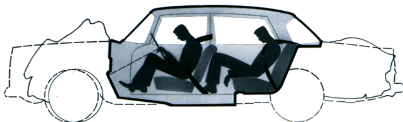
179. ábra: A gyűrődő zóna viselkedése ütközés esetén
