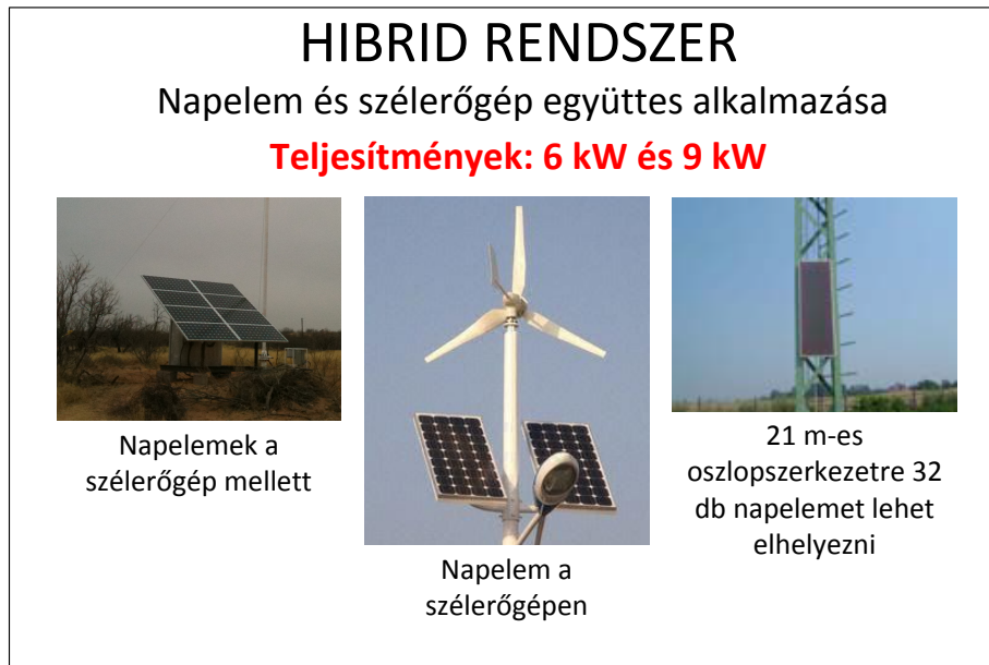
239. ábra: Napelem és kis teljesítményű szélérőmű villamos energia ellátó rendszerektől távolabb eső területek villamos energia ellátására [13] [24]
