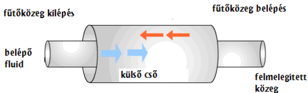
119. ábra: Egyenáram és ellenáram animációja cső a csőben típusú hőcserélőben (Animáció angol nyelven: http://www.rpaulsingh.com/animated%20figures/fig4_6.htm )
