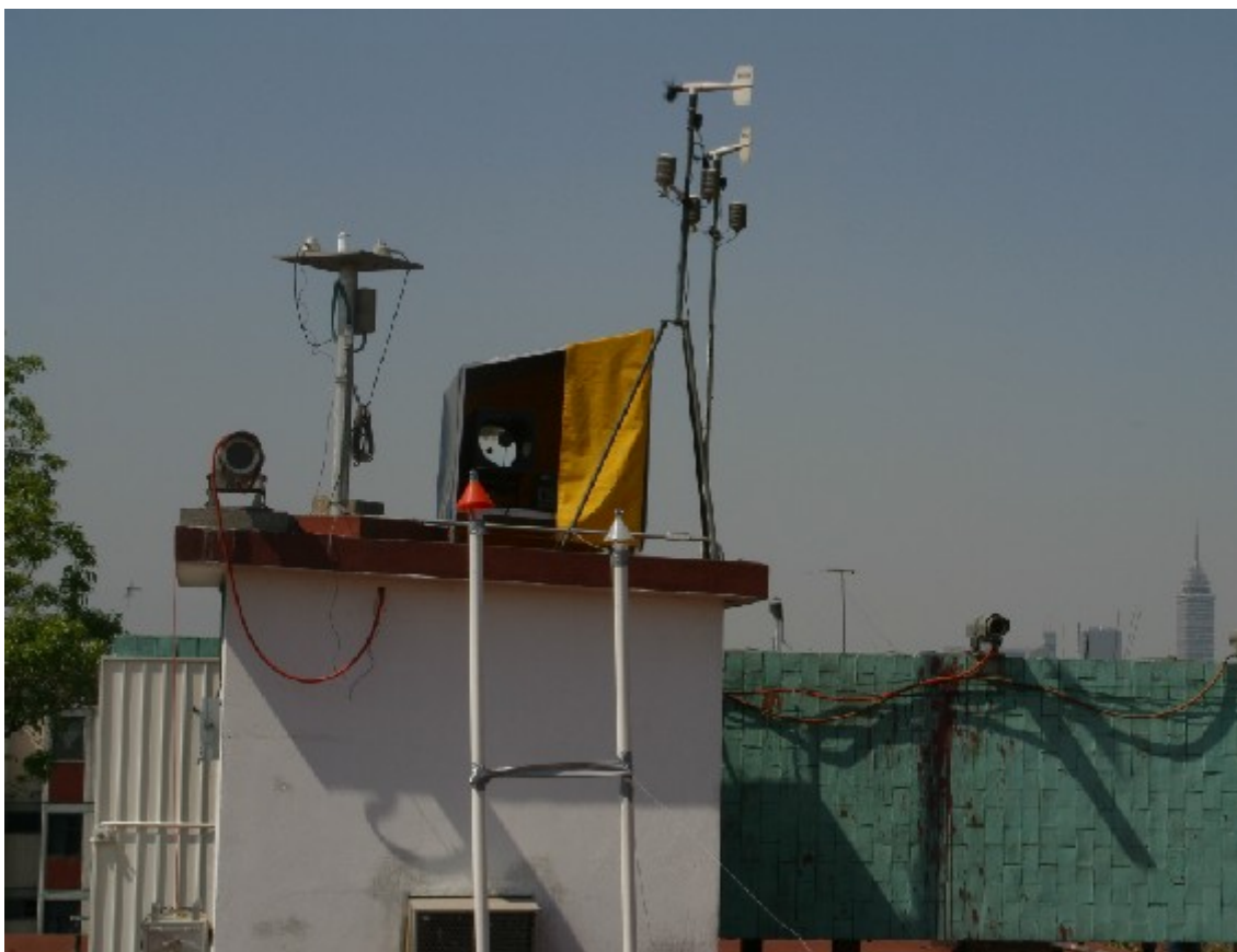
37. ábra Az OP-FTIR berendezés adó oldala
