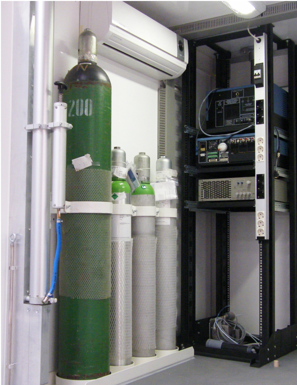
37. ábra A légszennyező anyagok mennyiségi és minőségi műszeres meghatározása előtt tanúsított gázpalackokkal történő kalibráció szükséges
