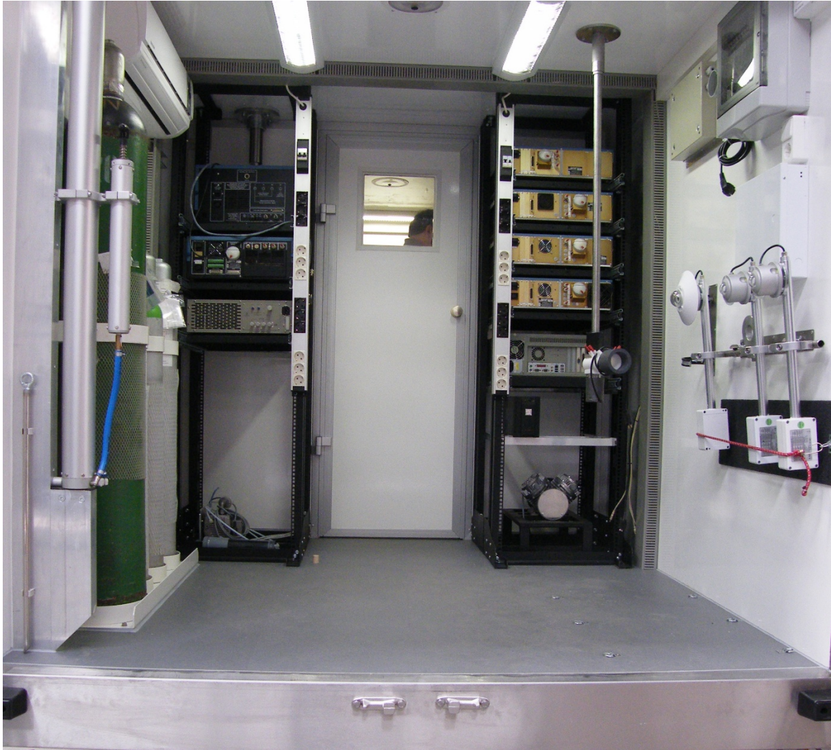
36. ábra Korszerű immissziós (mobil) laboratóriummal mérhető a tényleges légszennyezettség
