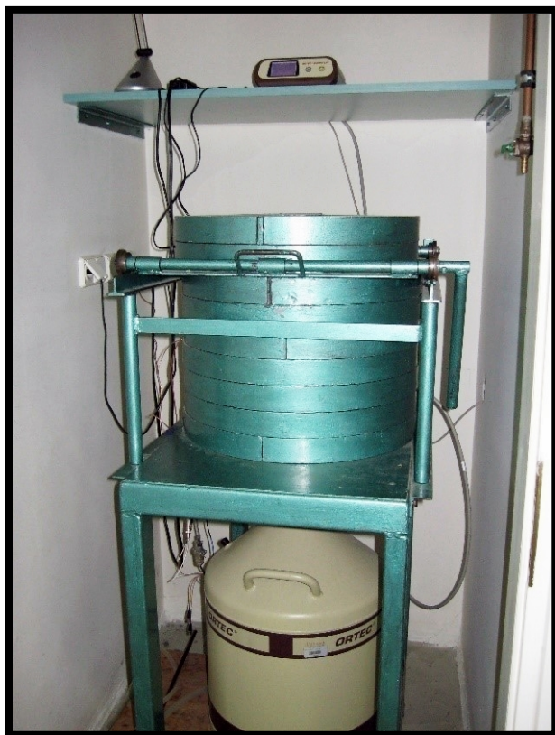
11. ábra Félvezető detektoros gamma-spektrométer rendszer árnyékolással
