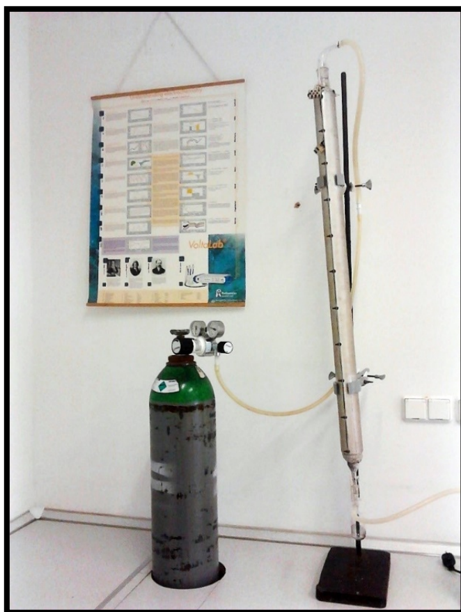
16. ábra Rézoszlopos oxigénmentesítő egység
