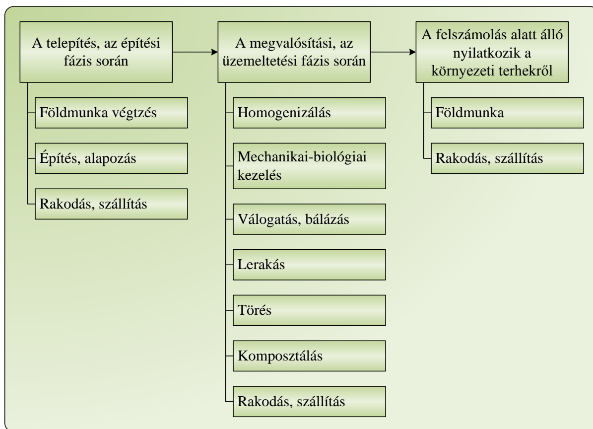
20. ábra Kommunális hulladéklerakó légszennyezést előidéző tevékenységei (hatótényezői)
