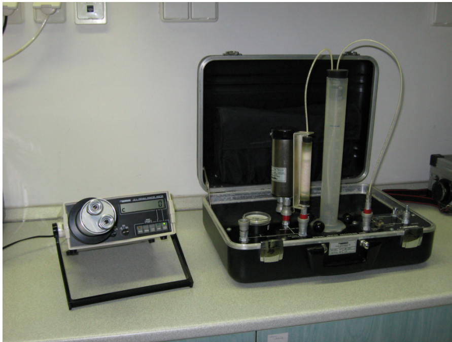
29. ábra WG-1001 típusú vákuumos víz-átbuborékolató rendszer, Pylon AB-5 radon monitor
