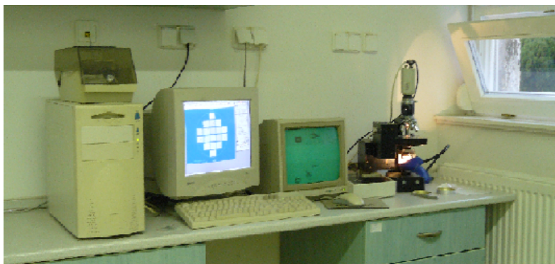
12. ábra Kiértékelő berendezés: kamera, a motorvezérelt optikai mikroszkóp és az ehhez csatlakoztatott számítógép
