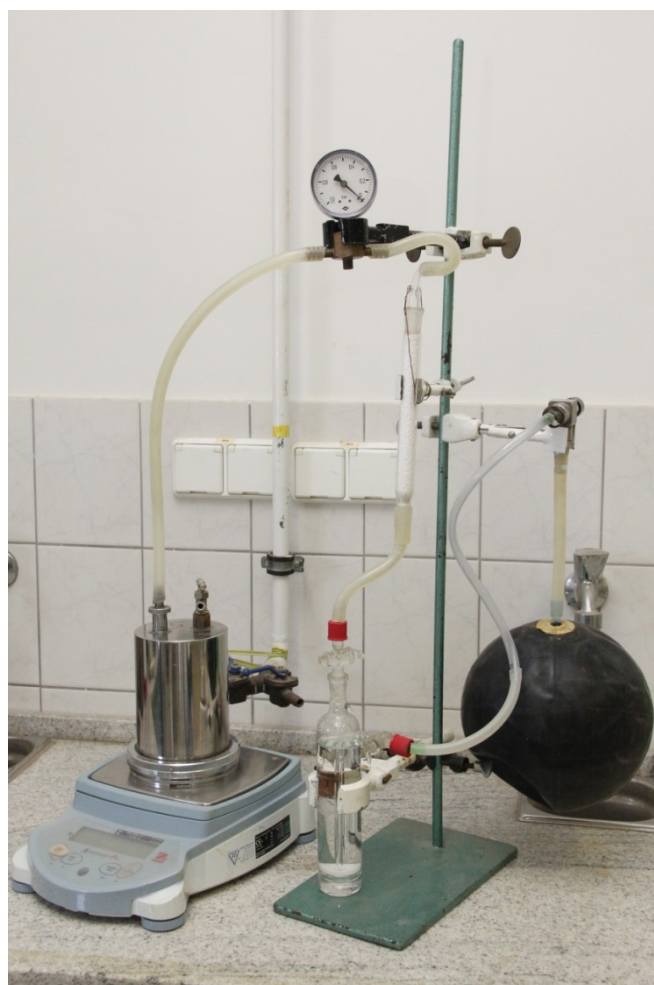
33. ábra A radon áthajtása a Lucas cellába
