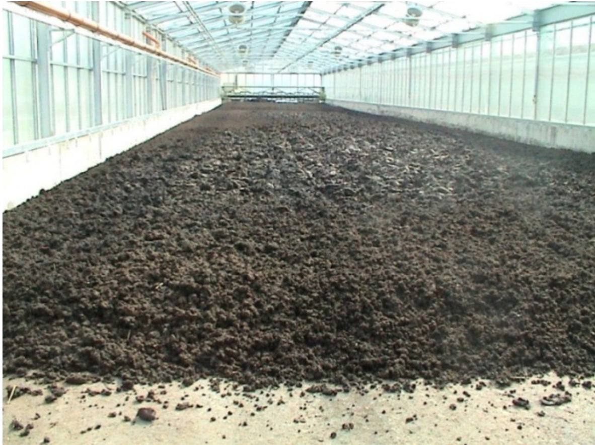
79. ábra Az iszapszárító sorok keverőszerkezete és felső ventilációjának (levegőkeverésének) kialakítása
