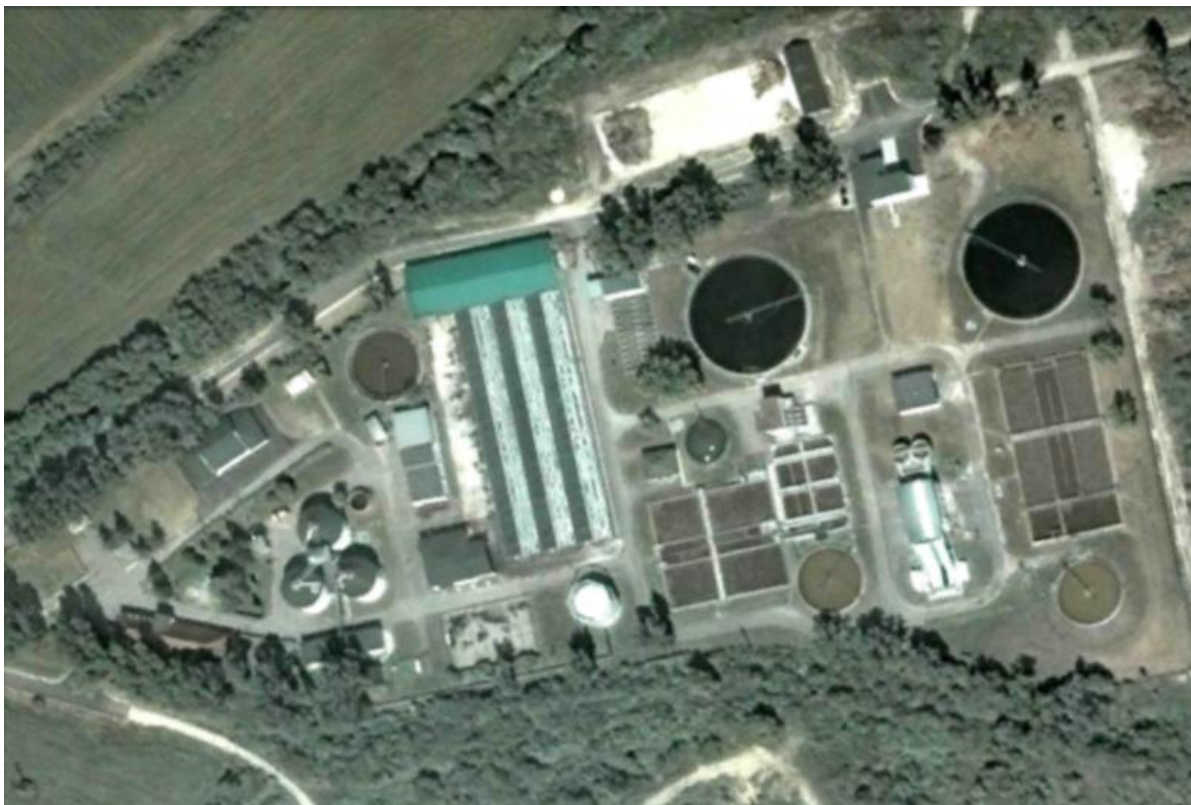
77. ábra A veszprémi napenergiával történő iszapszárító elhelyezkedése a szennyvíztelep közepén a rothasztó tornyok és az eleveniszapos medencék, utóülepítő között
