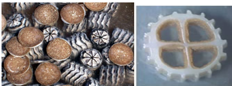
42. ábra: Klasszikus Kaldnes töltet (jobb oldali kép), valamint többrétegű biofilm hordozó a legkorszerűbb biochip lemezekkel (bal oldali kép).
