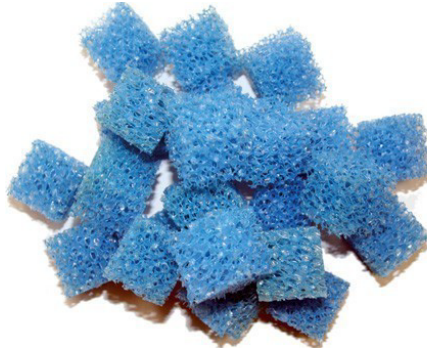
37. ábra: Polietilénből kialakított szivacszerű biofilm hordozó.
