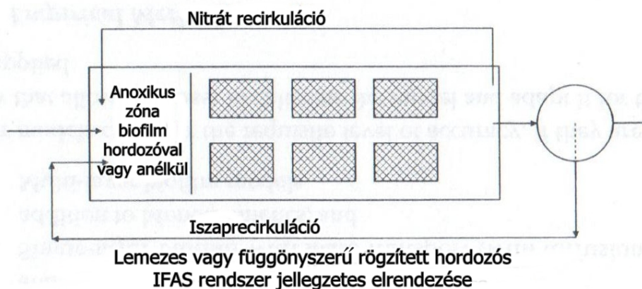
35. ábra: A rögzített biofilmes hibrid rendszerek sematikus kiépítése.
