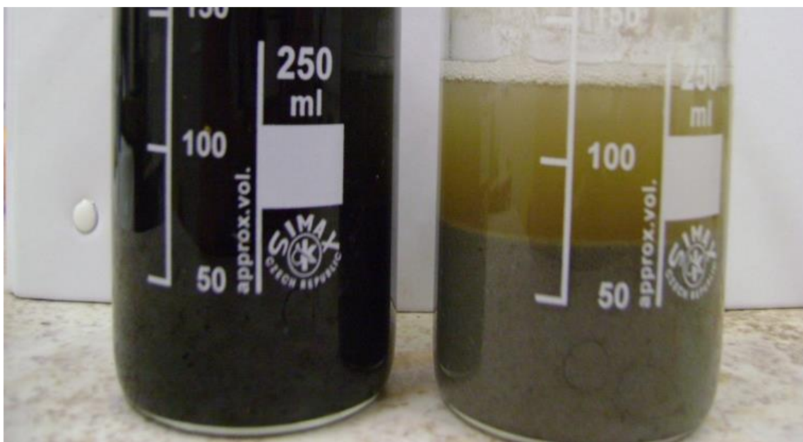
32. ábra Biogáz üzemi fermentlevé koaguláltatása Fe 3+ és polielektrolit segítségével.
