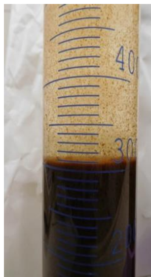
78. ábra A húsipari üzem SBR egysége iszapjának az ülepedés
