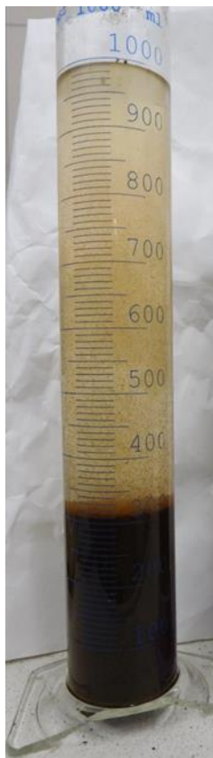
78. ábra A húsipari üzem SBR egysége iszapjának az ülepedés
