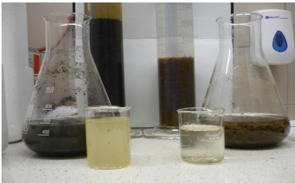
31. ábra A nyers szekunder (jobb oldalon) és kétszeresére hígított rothasztott lakossági iszap ülepedése menzurában, valamint kationos polielektrolitos flokkulációja után.
