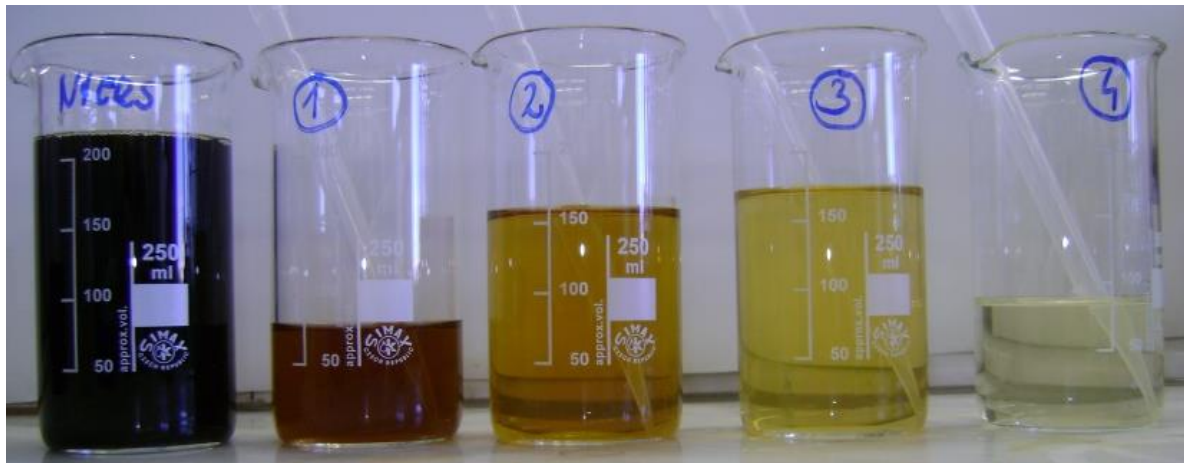
33. ábra Szilárd hulladéklerakó csurgalékvizének a kicsapatással előtisztított vízfázisa.
