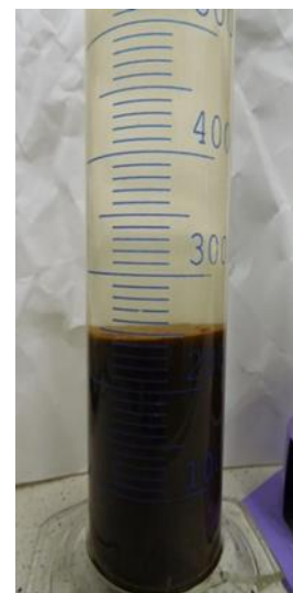
78. ábra A húsipari üzem SBR egysége iszapjának az ülepedés
