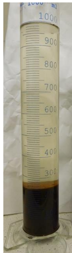
78. ábra A húsipari üzem SBR egysége iszapjának az ülepedés
